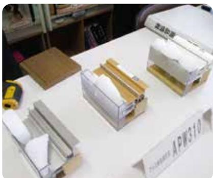
アルミタイプと樹脂タイプの模型にドライアイスをのせます。
